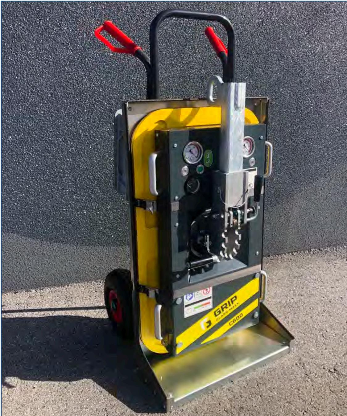
Der Vakuumheber C600/300 ist geeignet für Glasscheiben bis 600 kg. Er ist serienmäßig mit einem Doppelvakuumssystem ausgestattet für Lasten bis 300 kg. Das absolute Highlight der Maschine ist das äußerst geringe Eigengewicht für die Leistung, die sie bringt: Die Maschine selbst wiegt nur 30 kg! Als optionale Ausstattung der Maschine ist beispielsweise eine Radiolenkung oder verkürztem Hebearm verfügbar.
