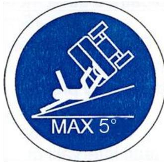
Nicht schnell oder ruckartig Kurven fahren, wenn Sie sich auf einer Neigung befinden, da die Gefahr des Umkippens besteht.
