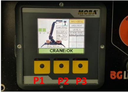
Nach der Stabilisierung ist die Maschine in der Lage, mit dem Kransystem zu arbeiten. Um diese Betriebsweise freizugeben, muss das Fahrzeug zuvor stabilisiert werden, die Raupenkettens müssen mindestens 100 mm (NICHT mehr als 300 mm) vom Boden angehoben sein, die Wasserwaage am Rahmen muss etwa 0° anzeigen und alle vier Stabilisatoren müssen auf den Boden gedrückt sein.
