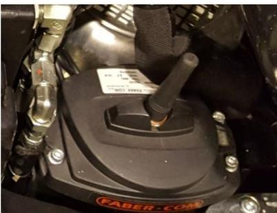
Die Notüberbrückung für die Funksteuerung am Kabel mit der Kennzeichnung „X7.C“ anbringen, das an den Sender der Funksteuerung angeschlossen ist.
