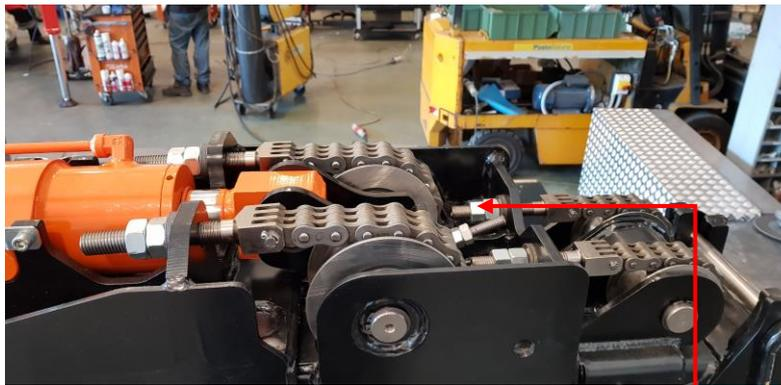
Prüfen Sie die korrekte Kettenspannung
