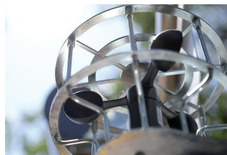
**Anemometer** zur Kontrolle und Warnung vor Erreichen der maximal zulässigen Windgeschwindigkeit (45km/h).
