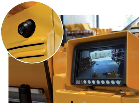
**Fahrkamera.** Um die Sicht für den Fahrer zu verbessern, ist es auf Wunsch möglich, eine Kamera und ein Display zu installieren, die eine bessere Sicht von der dem Korb gegenüberliegenden Seite ermöglichen. Außerdem wird auch die Ausrichtung zum Gleis erleichtert, wenn die Arbeitsbühne auf das Gleis einfährt.
