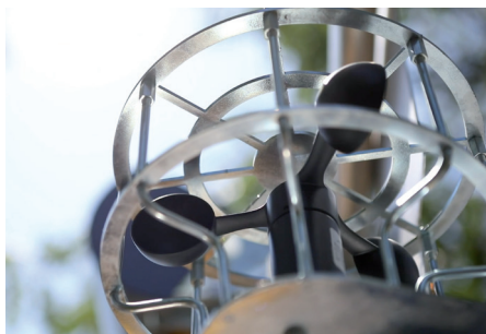
Anemometer zur Kontrolle und Warnung vor Erreichen der maximal zulässigen Windgeschwindigkeit (45km/h).
