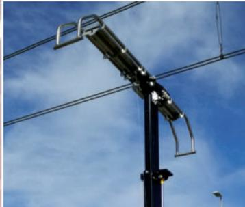
Optional kann ein Pantograph (auf Anfrage) für Erdungs- und Messarbeiten angebaut werden. Die Kontrolle der Oberleitungen, auch der Abstand zum Gleis sind somit einfach und sicher durchzuführen. Selbstverständlich besitzt der Pantograph die nötigen Zulassungen wie z. B. für den Betrieb in Frankreich.
