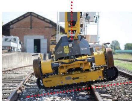
Die RR11T wird von einem leistungsstarken 10,5-kW Dieselmotor angetrieben. Als weitere Option kann die Maschine mit Lithium-Ionen-Batterien für den vollelektrischen Betrieb bestellt werden. Somit ist die RR 11T bestens für den Einsatz in Tunneln, U-Bahnen und im Innenbereich von Gebäuden wie z. B. Hallen oder Bahnhöfen einsetzbar.
