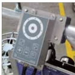
INTERCOM-Gerät für die Kommunikation zwischen Mensch am Boden und Personal im Luftkorb.
