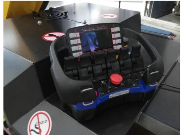
Abbildung 4 Scanreco Funkfernbedienung mit Diagnosedisplay
