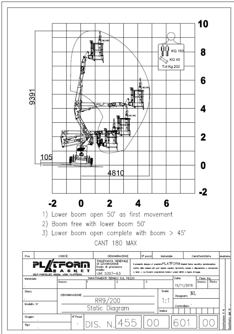
Abbildung 1 Zeichnung 455.00.601.00 Arbeitsdiagramm Arbeitsdiagramm auf Schiene
